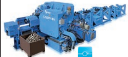
CADDY 80 Cisaille mécanique à froid pour billettes
