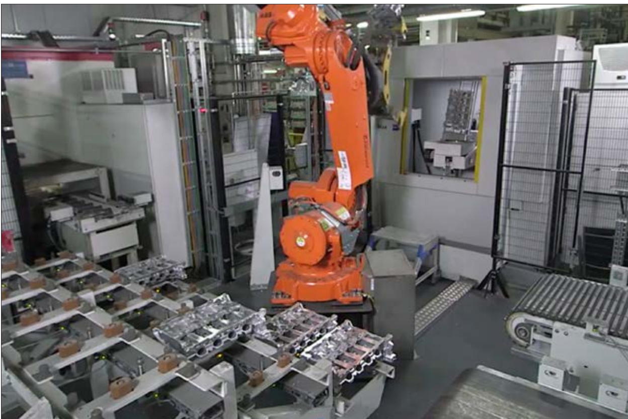
Contrôle de production de culasses par micro-tomographie en bord de ligne (BMW) - Image ZEISS
