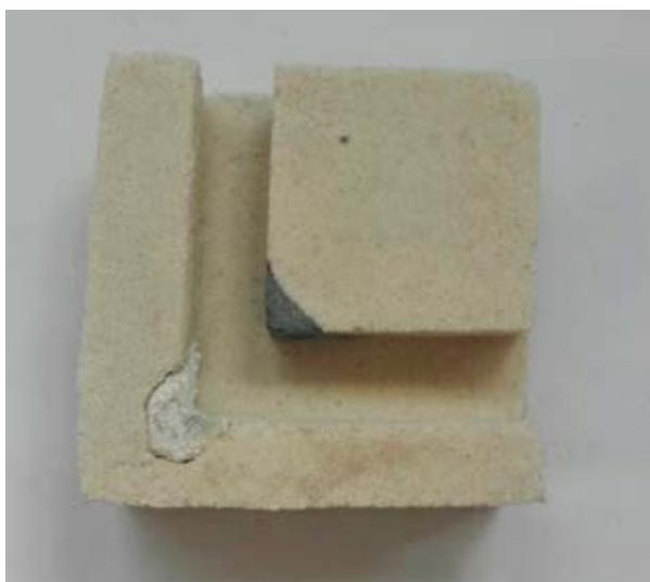
Fig. 22 : Coupe 2D du moule trimatériaux
