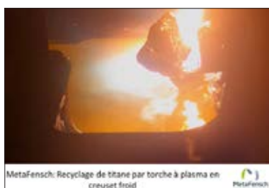
MetaFensch: Recyclage de titane par torche à plasma en creuset froid
