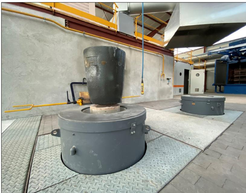
Photo 1 : Four à induction de type « push-out »
