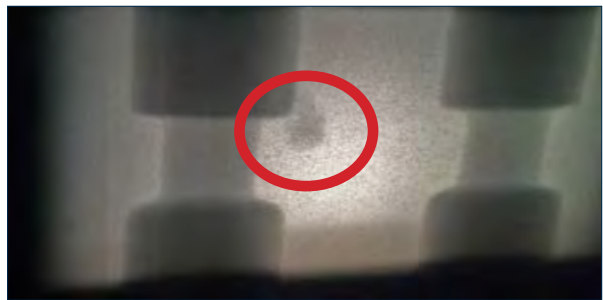
Vue de la pièce première fabrication présentant un défaut de retassure
