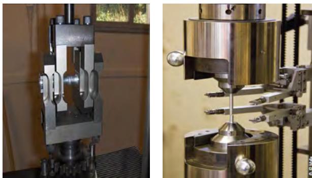
Figure 13 : Caractérisation des éprouvettes à défaut en fatigue. A gauche : flexion 4 point ; au centre : traction-compression ; à droite : courbes de Wöhler.
