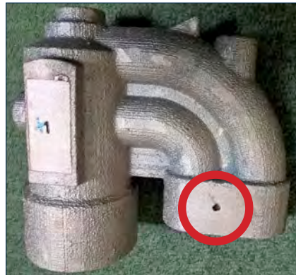
Vue de la pièce première fabrication présentant un défaut de retassure
