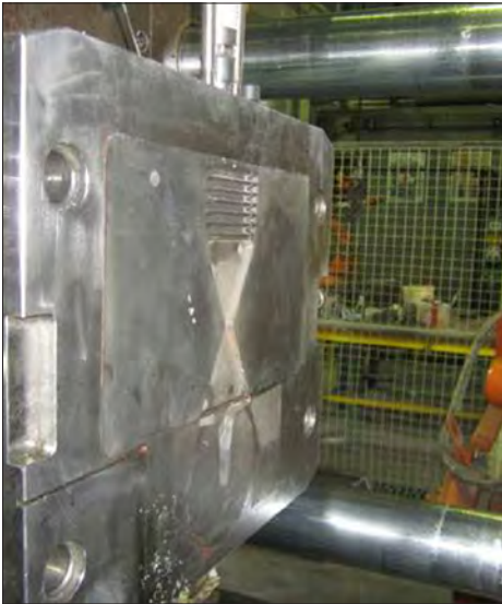
Figure 1 : Moule d'essai de coulée sous pression. Crédit photo : CTIF.
