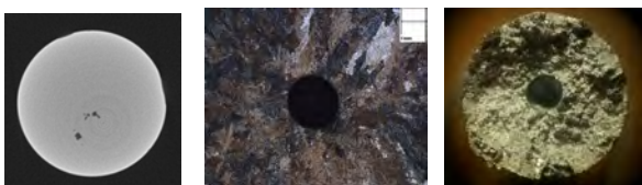
Figure 10 : Exemple de défauts contrôlés. A gauche : défaut naturel (retassure dans une éprouvette de 2 mm de diamètre, image de tomographie alliage Al Si13) ; au centre : défaut naturel (soufflure dans éprouvette acier martensitique I3-4) ; à droite défaut artificiel (défaut lenticulaire Ø2mm dans éprouvette de fatigue Ø10mm alliage Al Si7Mg0,6).
