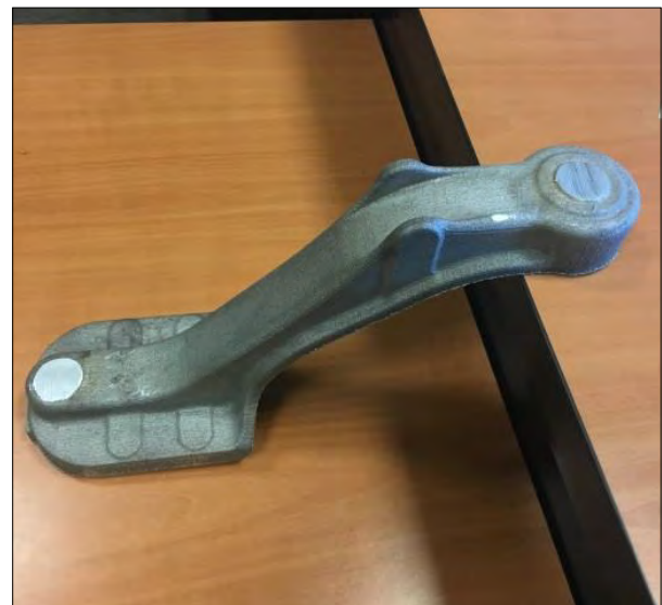
Figure 8 : Pièce saine réalisée à CTIF par voie de fonderie. Crédit photo CTIF.
